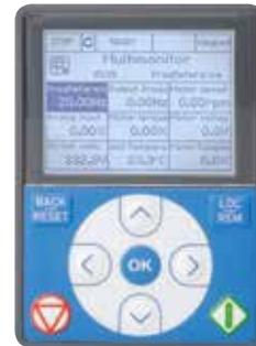
InterPuls新型iDrive100变频器可调节真空泵速度，从而减少了能耗、噪音和维护成本，也最大可能保证了挤奶时的真空稳定性。
